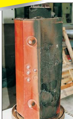
Катушка трансформатора Trihal после испытания F1
